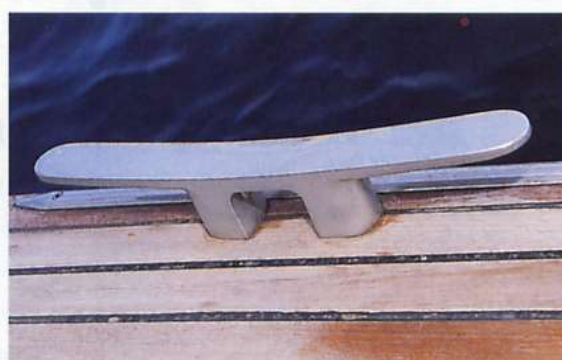
Un des taquets de garde, nombreux sur le pourtour du pont. On remarque la baguette d'usure en inox.
